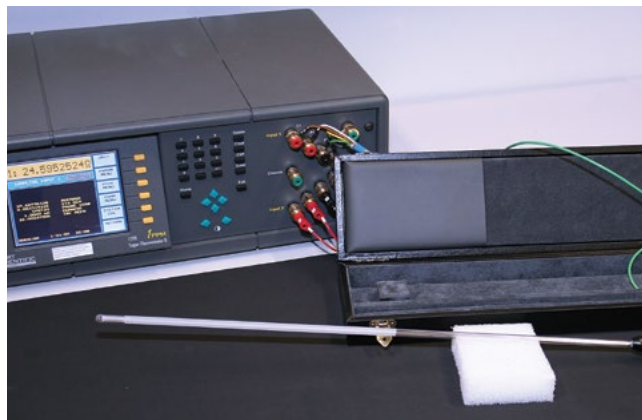
Termometr wzorcowy SPRT kalibrowany wg Międzynarodowej Skali temperatury ITS90
