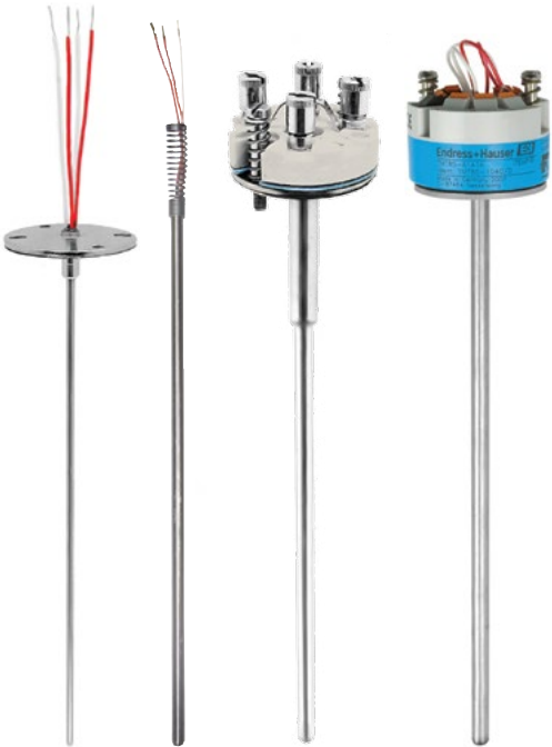
Wkłady pomiarowe: ze swobodnymi przewodami, z dociskiem sprężynowym bezpośrednio na wkładzie, z listwą zaciskową na bloku ceramicznym z wbudowanym przetwornikiem głowicowym.
