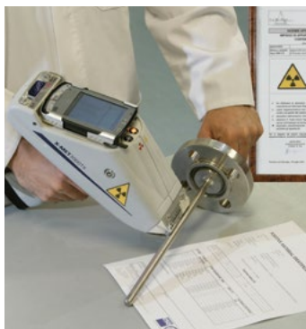
Analiza i badanie składu chemicznego metali (PMI) i optyczna kontrola jakości
