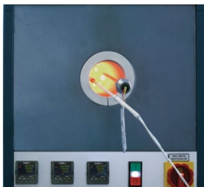
Próba wytrzymałości termicznej przez wygrzewanie w piecu o temperaturze 900 °C oraz hydrostatyczna długotrwała próba ciśnieniowa
