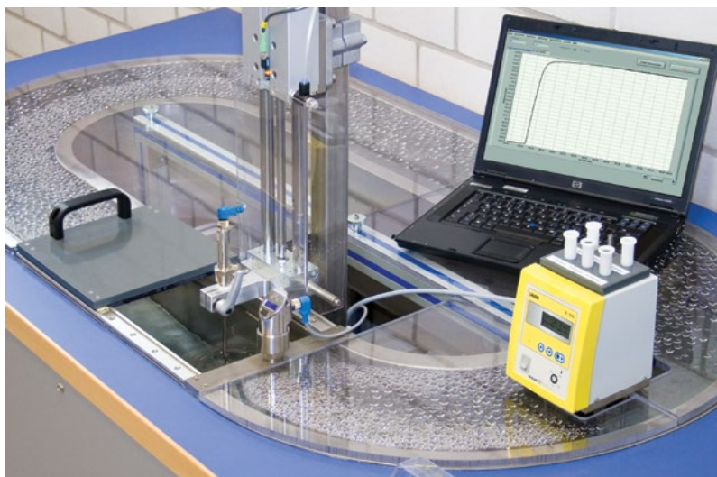
Stanowisko testowania czasu odpowiedzi w strumieniu wody
