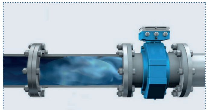
Rys. 10. Montaż za źle dopasowaną uszczelką między kołnierzami
