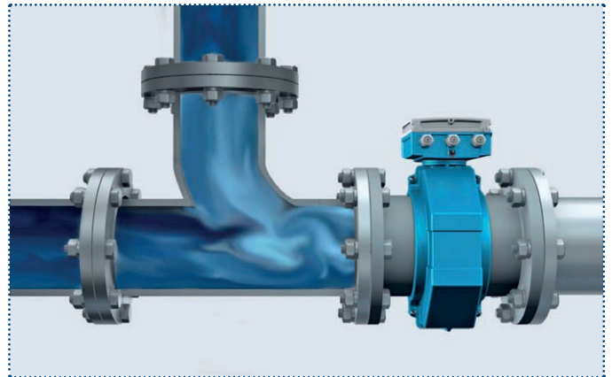
Rys. 9. Montaż za trójnikiem
