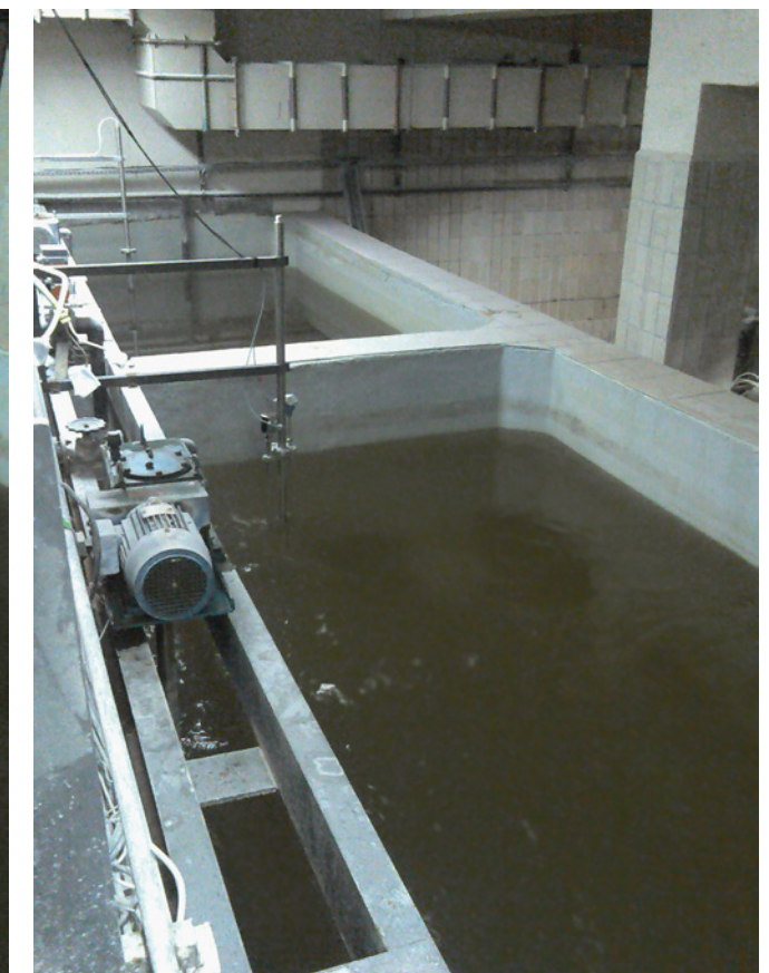
Czujnik wibracyjny Liquiphant Density i czujnik temperatury Omnigrad M TR10 w zbiorniku roztworu siarczanu glinu
