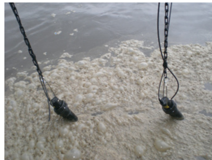
Sonda ISEmax zanurzona w ściekach
