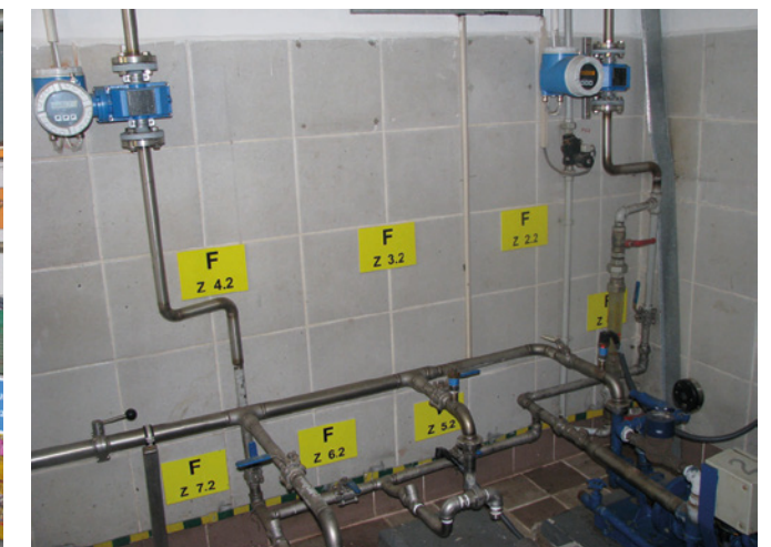
Pomiar gęstości osadu niesionego przez wodę w układzie bypass
