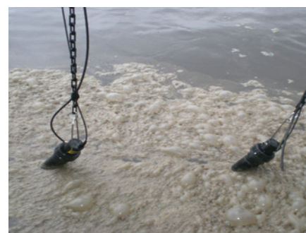
Sonda ISEmax zanurzona w ściekach
