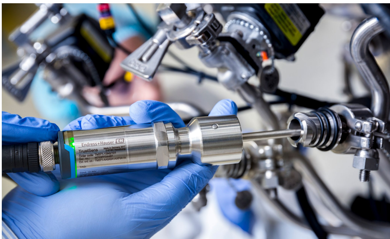
Samokalibrujący się termometr TrustSens z przyłączem technologicznym QuickNeck dla szybkiego demontażu bez użycia narzędzi.
