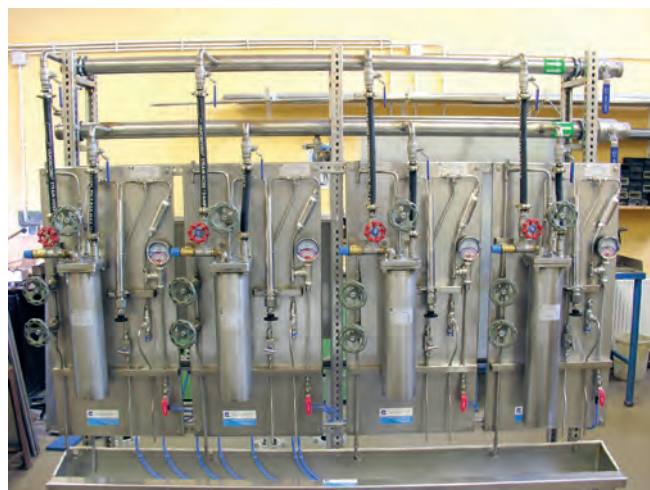
Rys. 1. System poboru i przygotowania próbek, prod. ENERGOPOMIAR
