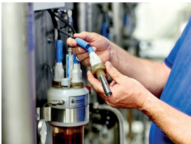
Rys. 4. Czujnik przewodności elektrolitycznej CLS15D prod. Endress+Hauser
