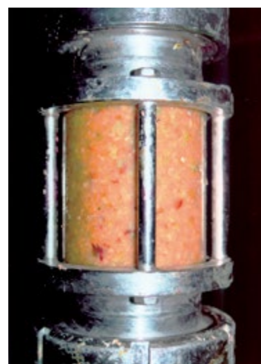
Przepływ cieczy o dużej zawartości części stałych
