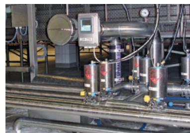
Maszyna do czyszczenia form: pomiar przewodności przetwornikiem CLD134
