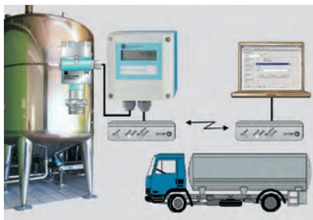
Pomiar poziomu melasy w zbiornikach magazynowych monitorowanych przez dostawcę. Minilog B rejestruje zużycie produktu przez użytkownika i zapewnia dostawcy informację o aktualnym poziomie w zbiorniku magazynowym. Dane są gromadzone w centralnym punkcie logistycznym, gdzie są wykorzystywane do planowania dostaw we właściwym czasie.
