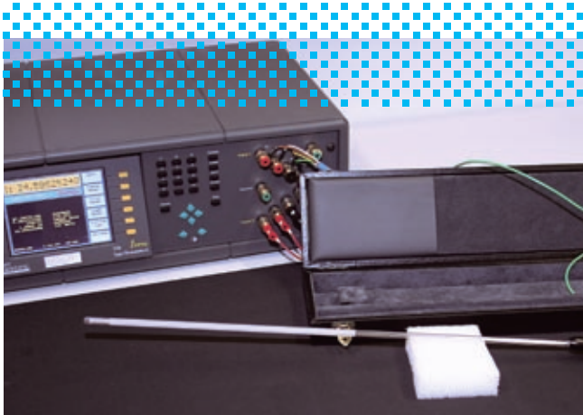
Termometr wzorcowy SPRT (ang. Standard Platinum Resistance Thermometer - wzorcowy platynowy termometr rezystancyjny) kalibrowany wg Międzynarodowej Skali temperatury ITS90.
