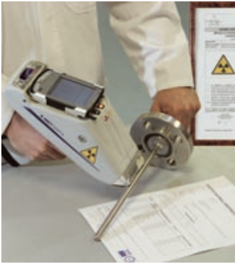
Badania identyfikacyjne materiałów (PMI) i optyczna kontrola jakości
