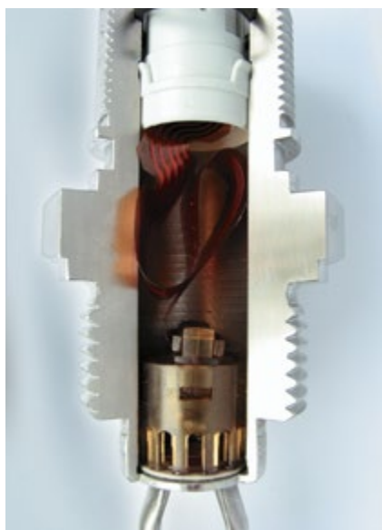
Napęd bimorficzny lub stos piezoelektryczny - serce wibracyjnego sygnalizatora poziomu Endress+Hauser
