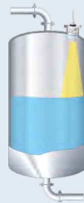
Zbiornik magazynowy z zamontowanym radarem bezkontaktowym FMR10 lub FMR20
