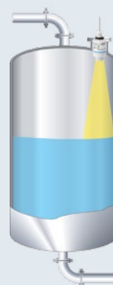
Zbiornik z zainstalowanym radarem bezkontaktowym
