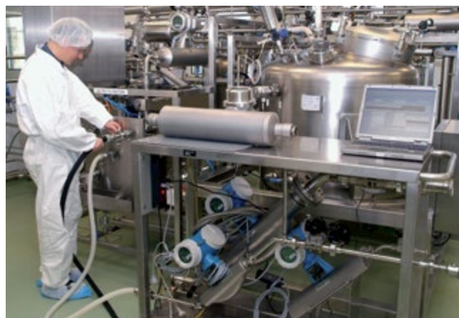
Kalibracja przepływomierzy, czujników ciśnienia, temperatury, pH oraz przewodności z wykorzystaniem przenośnego, kompletnego stanowiska kalibracyjnego
