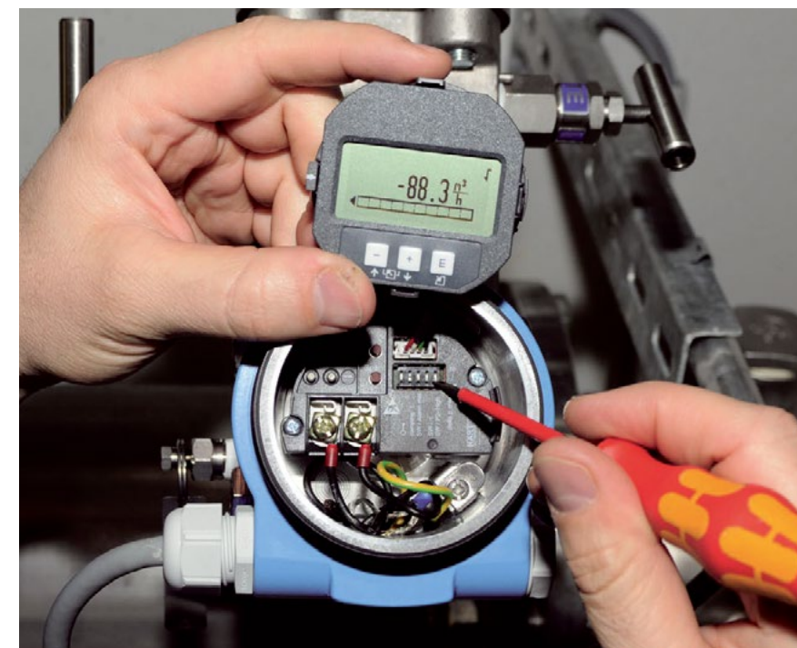
Dopasowanie ustawień Deltabar M do indywidualnych wymagań za pomocą wyświetlacza LCD lub mikroprzełączników
