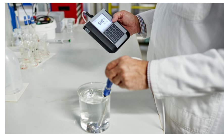
Wieloparametrowy przetwornik Liquiline To Go – przenośne urządzenie do pomiaru pH/redoks, przewodności elektrolitycznej i tlenu
