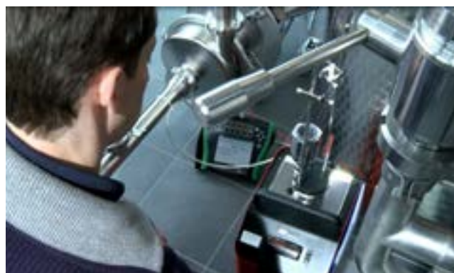
Wzorcowanie termometru iTHERM TM411
