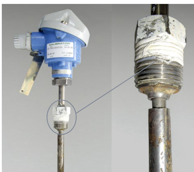
Spawana osłona o średnicy 9 mm i długości zanurzenia 270 mm, zamontowana na przewodzie wodnym. Pękła wskutek oddziaływania drgań wywołanych efektem Karmana.
