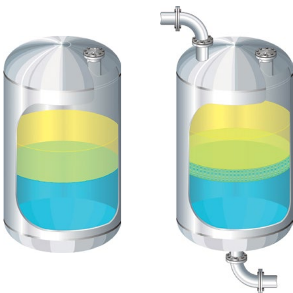
Wyraźny rozdział faz cieczy w zbiorniku magazynowym
