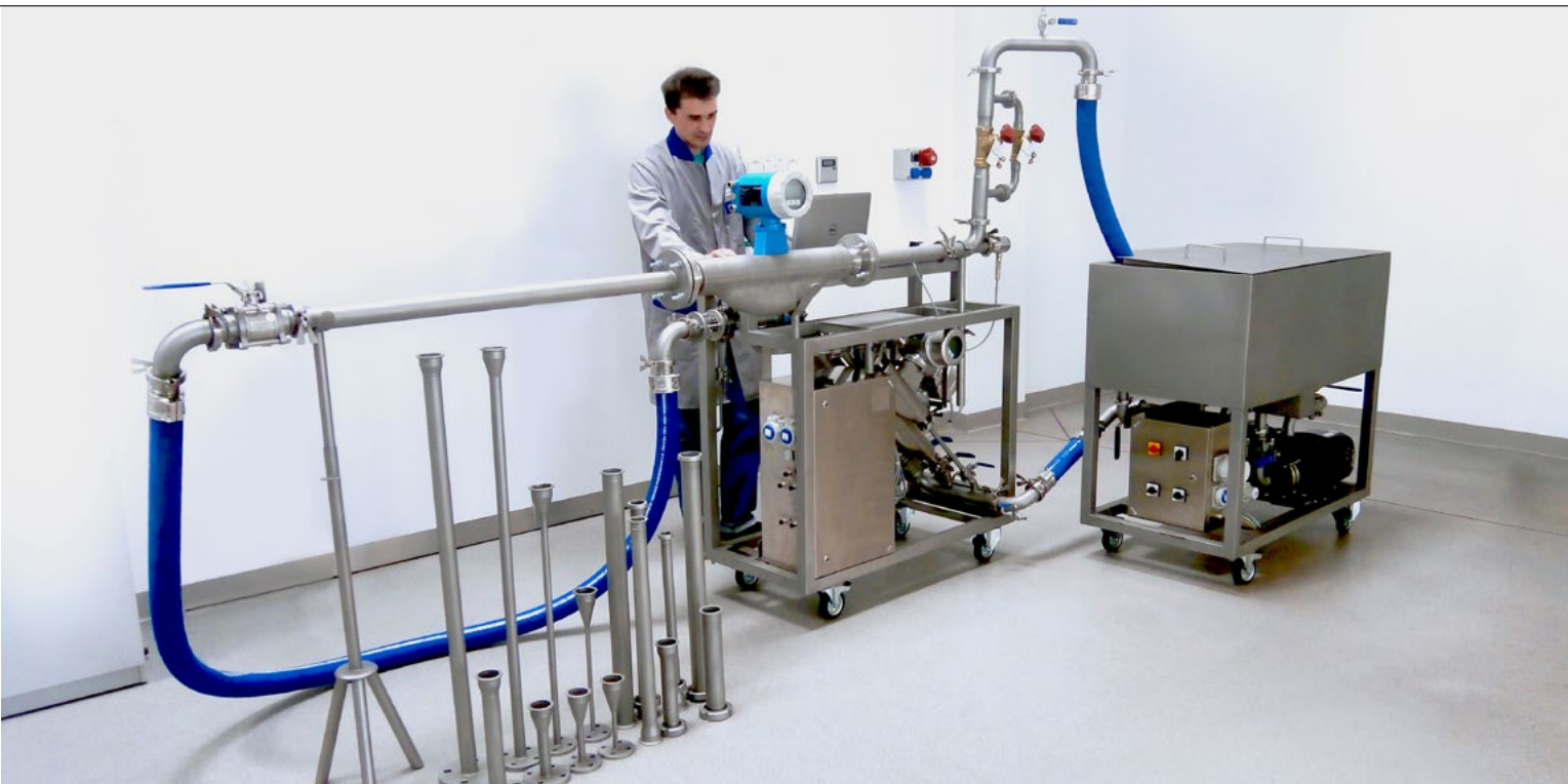
Wojciech Machnicki – Inżynier serwisu Endress+Hauser – podczas wzorcowania przepływomierza na mobilnej stacji kalibracyjnej
