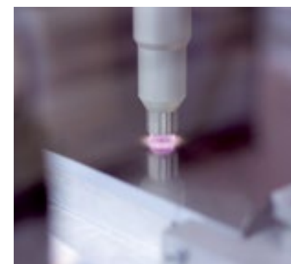
Obudowy przygotowywane do oklejenia stacji do poboru próbek w trakcie czyszczenia plazmowego.
