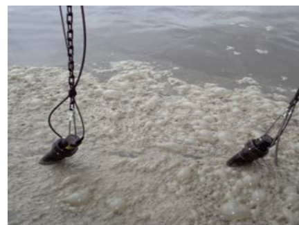
Sonda ISEmax zanurzona w ściekach
